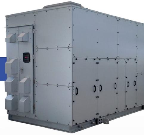
**CHRIS** hace posible deshumidificar en circunstancias de baja temperatura con una operación de mayor ahorro de energía aplicando una bomba de calor que utiliza dióxido de carbono como fuente de calor de regeneración. **CHRIS** tiene un COP total de más de 6 que disminuye drásticamente el consumo de energía. Además se utiliza refrigerante natural de dióxido de carbono, amigable con el ambiente.
